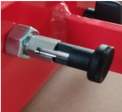
Im ersten Schritt werden sowohl die Rastbolzen, als auch die Flügelschrauben herausgedreht, damit diese nicht beim Einsetzen der Aufnahme stören. Hierzu zieht man den Rastbolzen ein Stück nach hinten und dreht ihn um ca. 45°, sodass er nicht wieder in seine Ausgangsposition springen kann.
